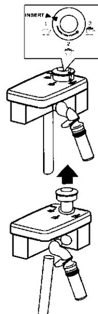
5. Ополоснуть место установки рукоятки регулировки пены с помощью проточной воды (смотреть иллюстрацию).
