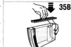
6. Вставьте фильтр в специальное гнездо (рис. 35A) и нажмите до упора, закройте бачок крышкой (рис. 35B), потом поверните бачок на свое место в аппарат;
